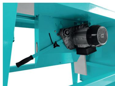
Le H 110 VR PLUS est équipé d'un levier permettant de régler la hauteur de coupe de 0 à 110 mm.
